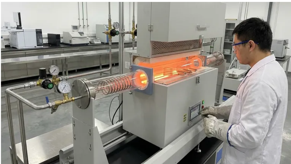
Abbildung 2. Anlage zum Wasserstoffglühen. 8
