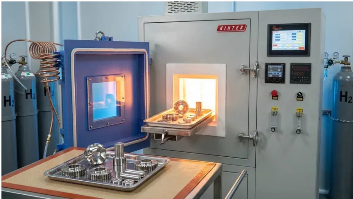
Abbildung 3. Anlage für das Sintern mit Wasserstoff. 10
