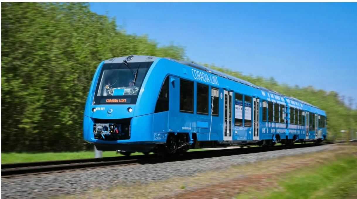
Abbildung 5. Der Brennstoffzellenzug Cordia iLint der Firma Alstom.
