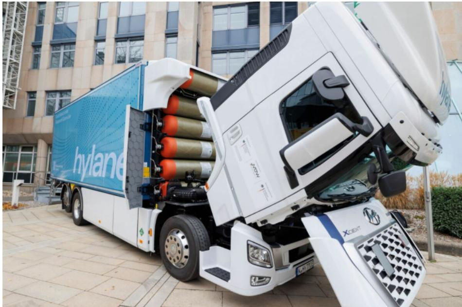
Abbildung 3. Wasserstoffbetriebener Lkw mit Wasserstoffdruckflaschen hinter der vorgeklappten Fahrerkabine.<sup>45</sup>
