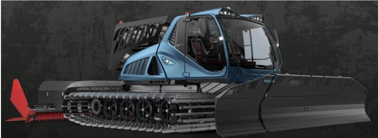
Abbildung 10. Schneeraupe von Pinoth mit Wasserstoffantrieb.
