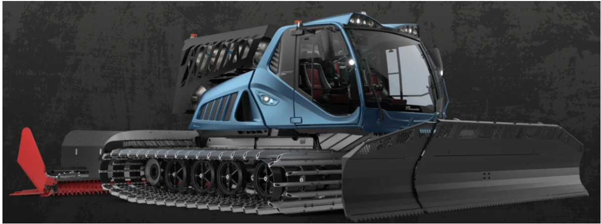
Abbildung 10. Schneeraupe von Pinoth mit Wasserstoffantrieb.
