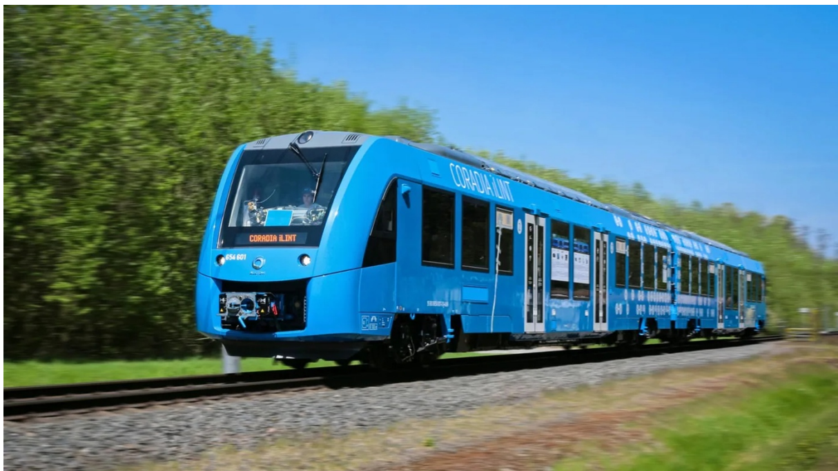
Abbildung 5. Der Brennstoffzellenzug Cordia iLint der Firma Alstom.
