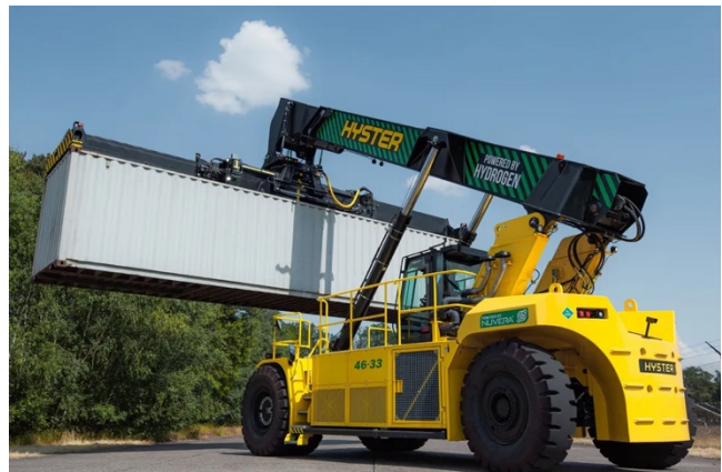
Abbildung 9. Brennstoffzelleneinheit von Plug Power für Gabelstapler und ein wasserstoffbetriebener Reachstacker von Hyster Yale.
