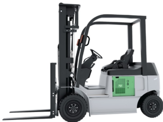
Abbildung 9. Brennstoffzelleneinheit von Plug Power für Gabelstapler und ein wasserstoffbetriebener Reachstacker von Hyster Yale.
