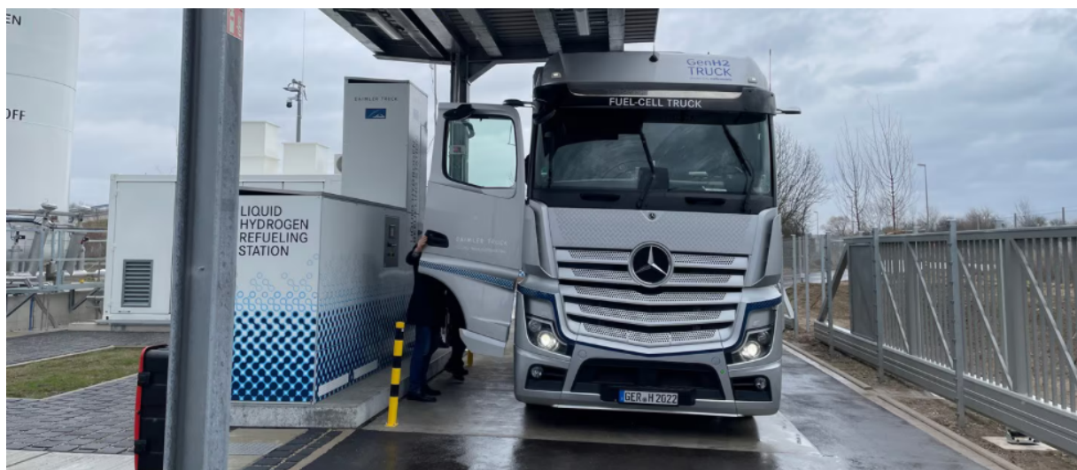
Abbildung 12. Erste öffentliche Lkw-Tankstelle für flüssigen Wasserstoff auf dem Industriegelände in Wörth.
