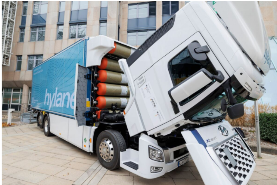
Abbildung 3. Wasserstoffbetriebener Lkw mit Wasserstoffdruckflaschen hinter der vorgeklappten Fahrerkabine. 45
