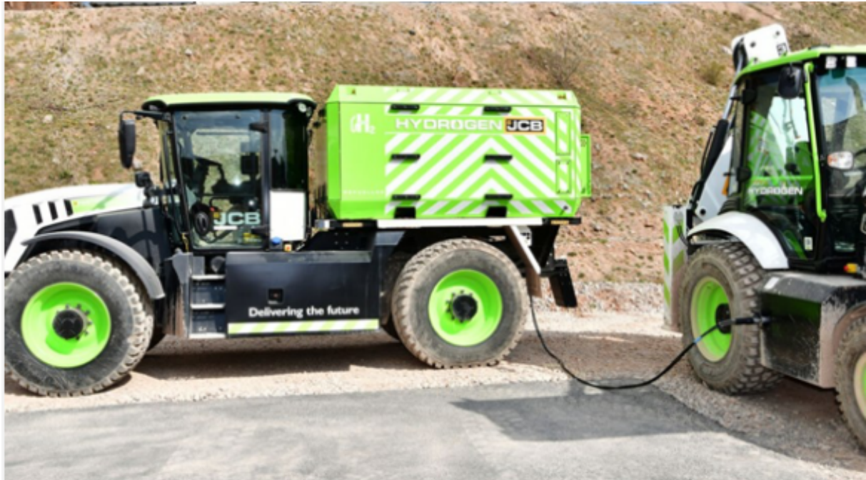
Abbildung 7. Mobile Wasserstoffbetankungsanlage von JCB bei der Betankung eines wasserstoffbetriebenen Baggers.
