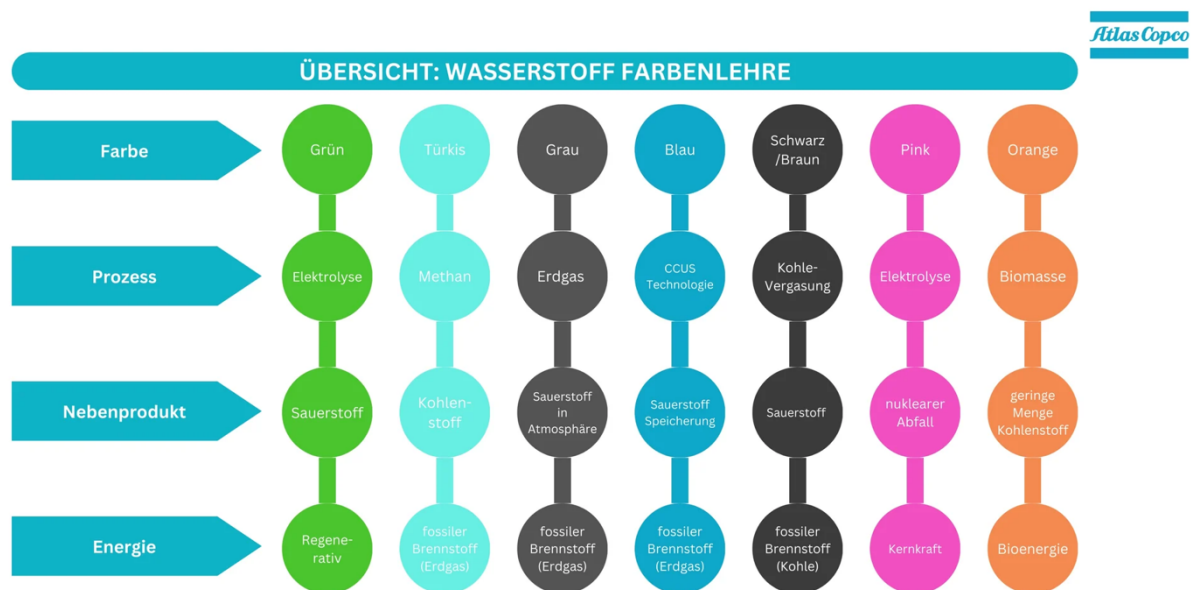
Abbildung 1. Übersicht über die Farbuordnung zu Wasserstoff aus unterschiedlichen Herstellungsverfahren. Ergänzt wird auch über gelben Wasserstoff aus Elektrolyse mit Netzstrom-Mix und weißen bzw. goldenen Wasserstoff aus natürlichen Quellen gesprochen. 1
